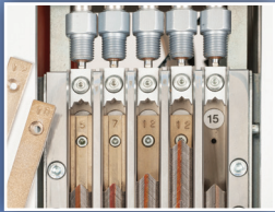
Inserciones de Canales-V intercambiables -para tamaños diferentes de clavos en V
