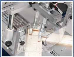
Presor doble de presión hidráulica para la moldura
